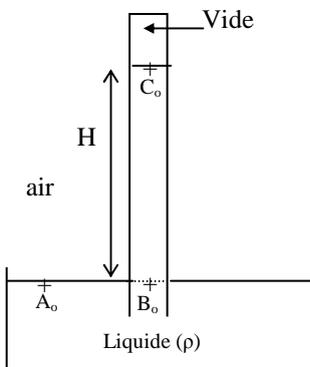
Continuité de la pression à la traversée de la surface de séparation air-liquide et vide - liquide :  $P_{A_o} = P_o$  et  $P_{C_o} = 0$  (1)
